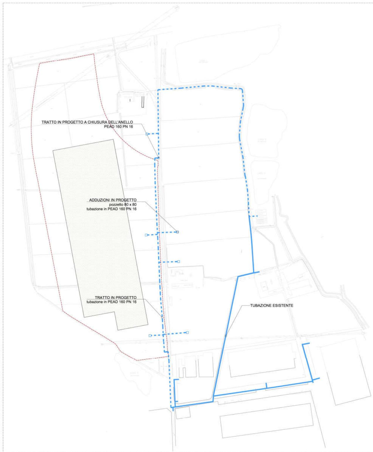
Figura 22 – Tracciato ipotetico della rete acquedotto esistente e in progetto
