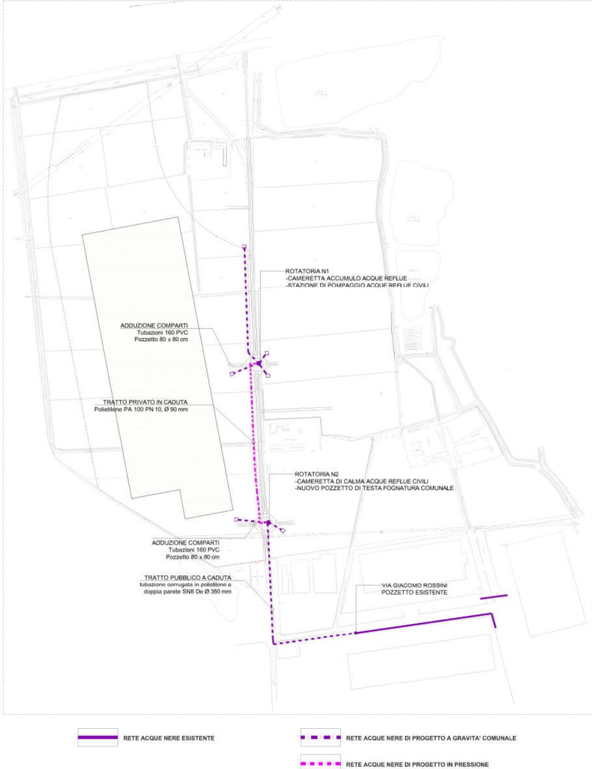
Figura 23-Tracciato ipotetico della rete fognaria esistente e in progetto
