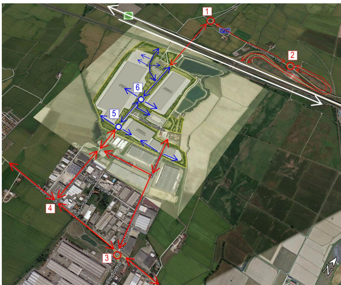
Figura 31 Schema rete viabilistica di progetto - in blu le tratte interessate dagli interventi previsti dallo Studio Generale, i punti 5 e 6 corrispondono alle rotatorie di progetto N1 e N2 afferenti alla realizzazione del Comparto 1.
