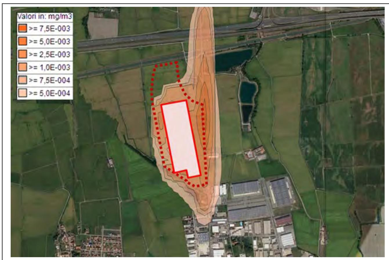
Fig. 37 Inquinante CO: Mappa delle concentrazioni massime [mg/m<sup>3</sup>] mediate su 8 h –
