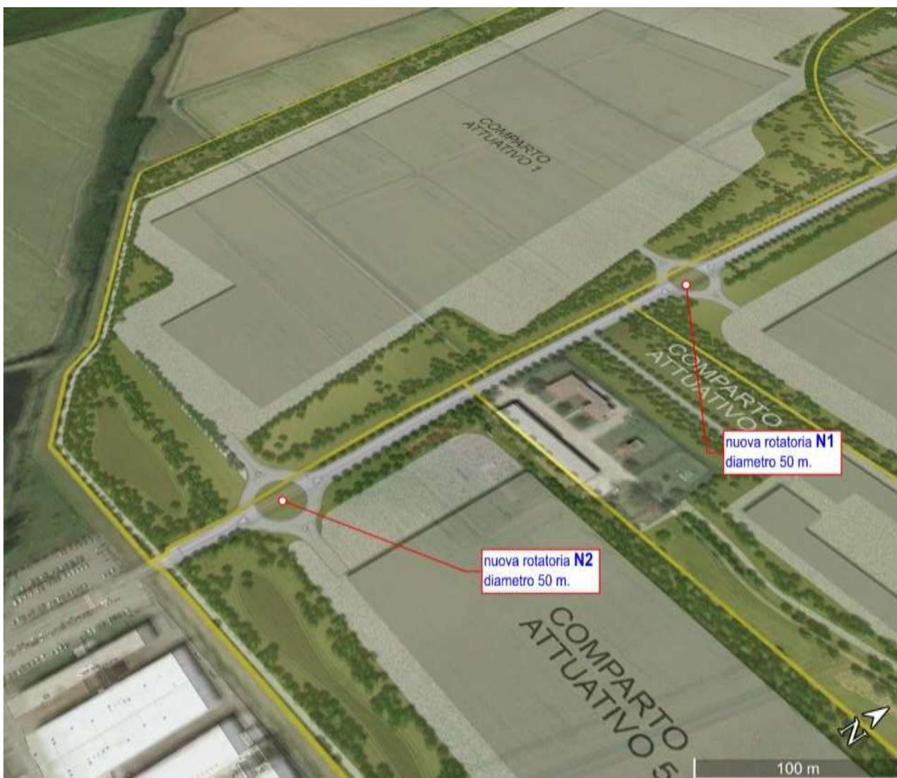
Figura 67 Schema Masterplan - localizzazione rotonde di nuova realizzazione
