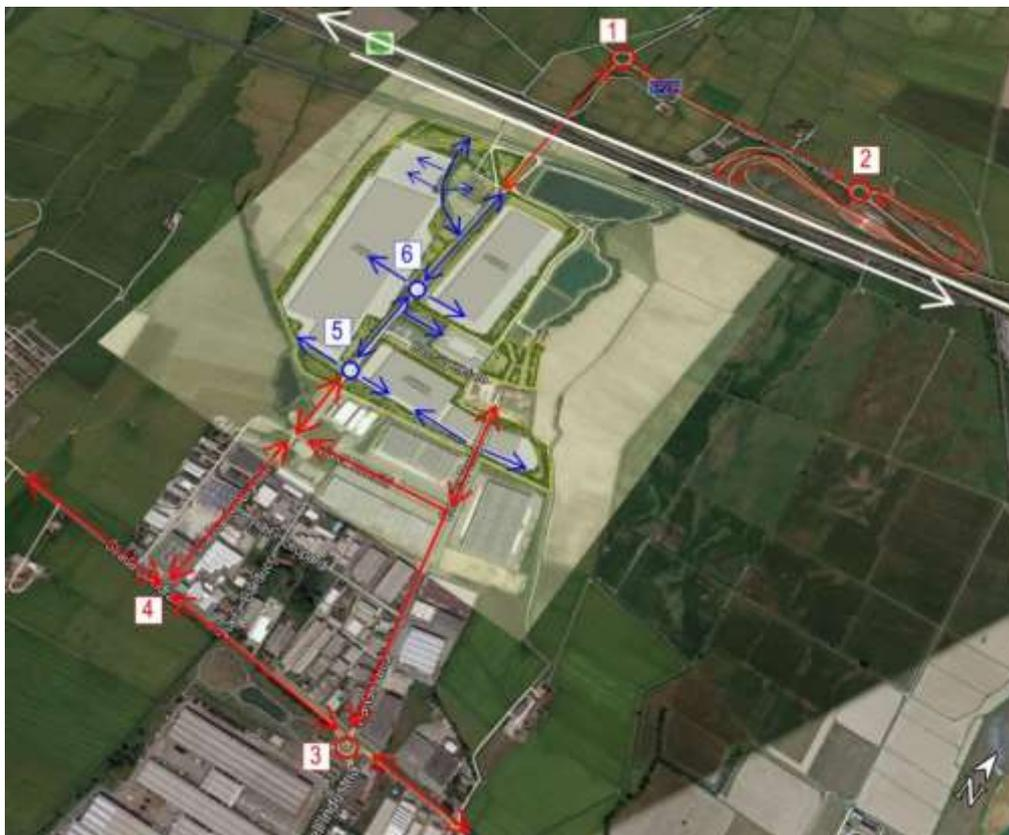
Figura 52 Schema rete viabilistica di progetto ambito nord- in blu le tratte interessate dagli interventi previsti dallo Studio Generale, i punti 5 e 6 corrispondono alle rotatorie di progetto N1 e N2 afferenti alla realizzazione del Comparto 1.
