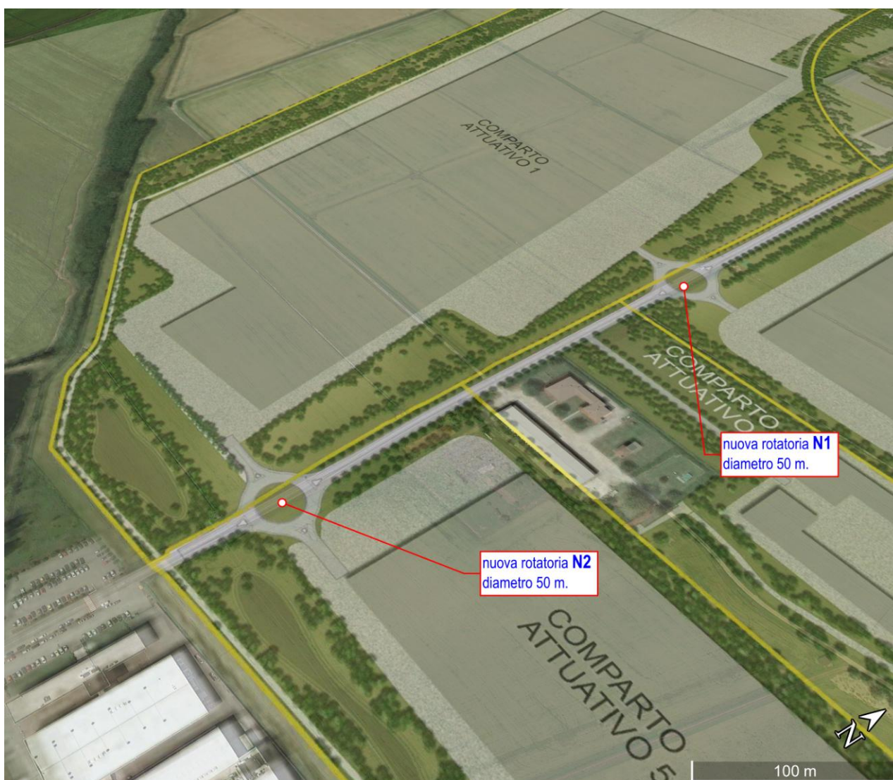
Figura 37 Schema Masterplan - localizzazione rotonde di nuova realizzazione
